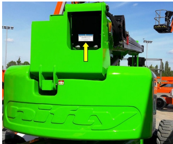
Afbeelding 2 – Locatie label op de buitenkant van de uitschuifbare scharnierbus van de HR28.
