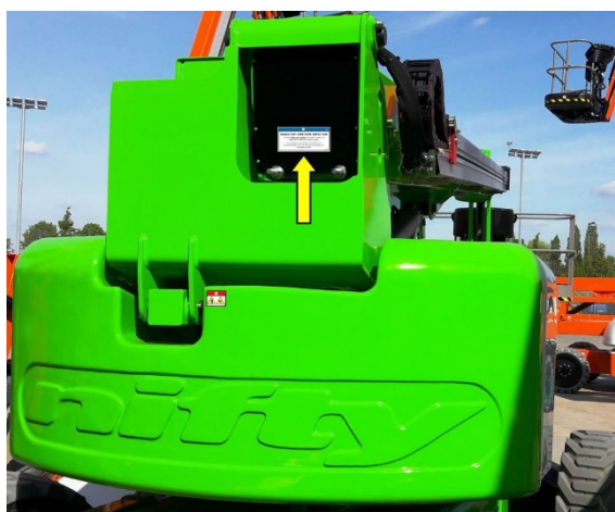
Figure 2 - Emplacement de l'étiquette sur le couvercle de l'articulation du télescope HR28
